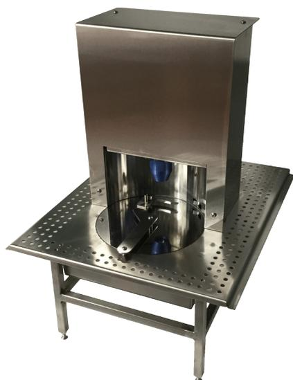
Station de sertissage électrique automatique en acier inox intégrable dans un isolateur de production pharmaceutique avec commandes externes déportées.
