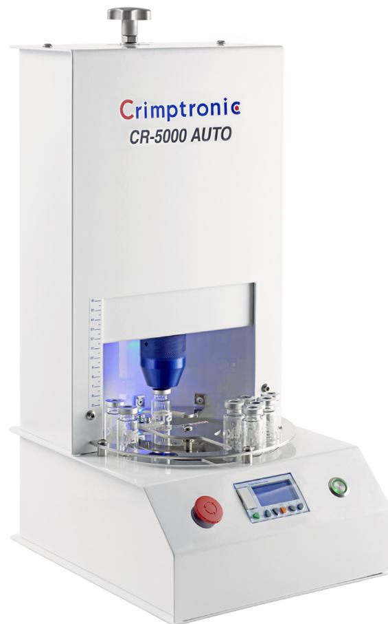
Le CR-5000 est polyvalente, stable, et permet d'ajuster avec précision la force de sertissage. Les têtes interchangeables pour le sertissage se montent rapidement sans outils et sont spécialement adaptées pour des fermetures en aluminium ainsi qu'en tôle d'aciers avec un diamètre de 8mm, 11mm, 13mm et 20mm. Des têtes spéciales sont disponibles pour des capsules flip-off de 13mm et 20mm.
