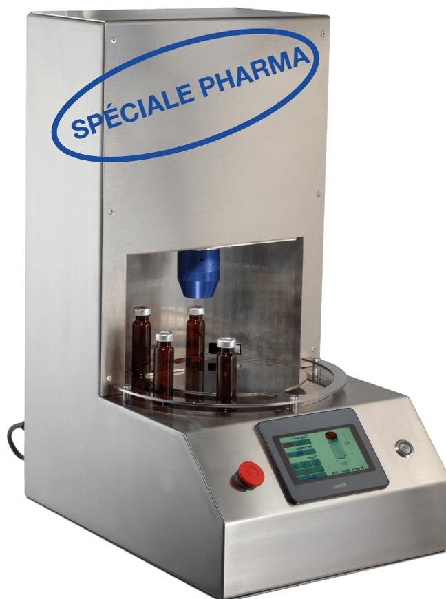
Le CR-5000S est polyvalent, stable et permet d'ajuster avec précision la force de sertissage. Les têtes interchangeable pour le sertissage se montent rapidement sans outils et sont spécialement adaptées pour des fermetures en aluminium ainsi qu'en tôle d'aciers avec un diamètre de 8mm, 11mm, 13mm et 20mm. Des têtes spéciales sont disponibles pour des capsules flip-off de 13mm et 20mm.
