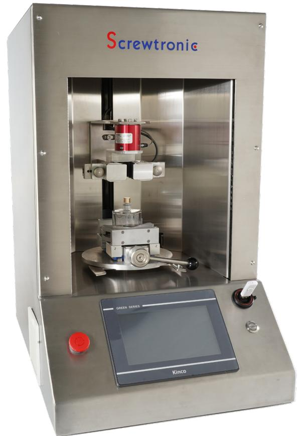
Station de vissage électrique à hautes performances spécialement développée pour le vissage à couple contrôlé de capuchons et fermetures en matière plastique avec ou sans bague d'inviolabilité, pompes de diffusion, pompes doseuses, comptes gouttes, ...
